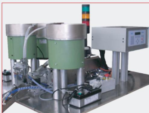
Alimentación de tornillo y tuercas con atornillador horizontal. Selección de pieza OK/NOK
