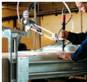
Los brazos de reacción facilitan al usuario las operaciones de ensamblaje pues se anula el peso de la herramienta, despeja el área de trabajo y se evita la reacción al par. **La ergonomía incrementa la productividad de sus procesos**, cuida la salud de los usuarios y favorece
