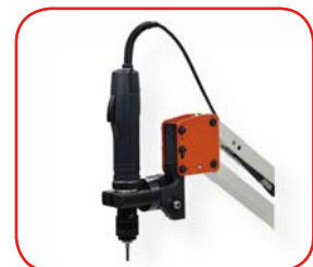
La brida puede girar libremente sobre el eje vertical
