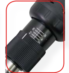
Regulación del par externa
